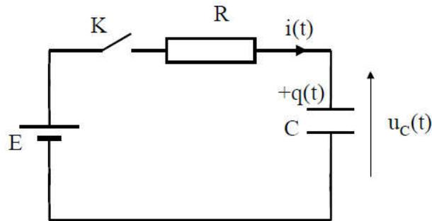
Pendant la charge, le courant contribue à augmenter la charge de la plaque positive du condensateur. On a donc, avec les conventions choisies sur la figure, la relation suivante :
