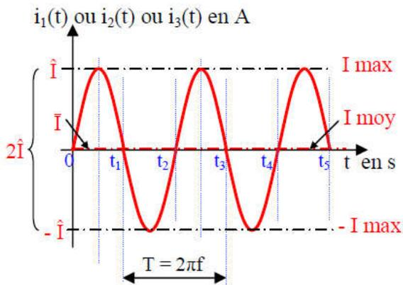
Comme en circuit monophasé, en circuit triphasé, un **courant alternatif sinusoïdal est un courant bidirectionnel, périodique et symétrique**. Il en est de même pour une tension alternative sinusoïdale.
