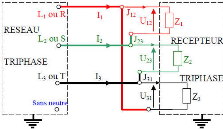
Dans un couplage triangle chacun des récepteurs est branché entre deux phases; La tension à ses bornes est donc la **tension composée** du réseau. Chacun des récepteurs est traversé par le **courant noté J** qui n'est pas le courant de ligne présent dans le conducteur qui l'alimente.
