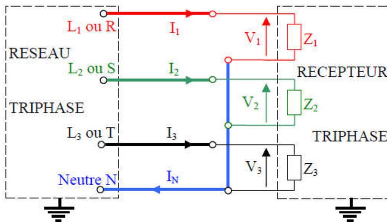
Dans un couplage étoile chacun des récepteurs est branché entre une phase et le neutre : La tension à ses bornes est donc la **tension simple** du réseau.
