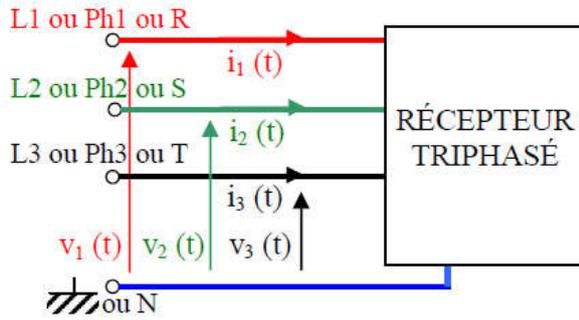
Un **circuit triphasé** est un circuit alimenté par **trois tensions alternatives sinusoïdales**  $v_1(t)$ ,  $v_2(t)$ ,  $v_3(t)$ , et parcouru par **3 courants alternatifs sinusoïdaux**  $i_1(t)$ ,  $i_2(t)$  et  $i_3(t)$ .
