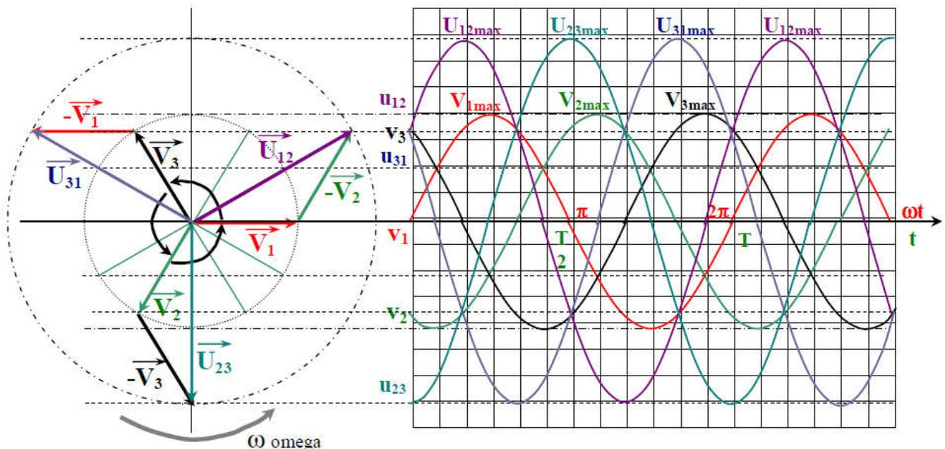
Sur la représentation de Fresnel on constate que les tensions composées sont en avance de phase de par rapport aux tensions simples de  $\pi/6$  rad.
